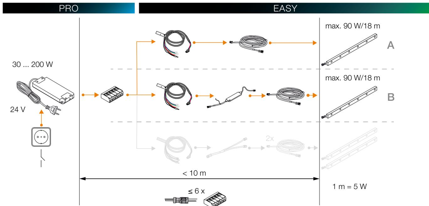
**Nota :** Longueur max. des modules LED du système LIPROTEC-EASY avec ajout de l'adaptateur Plug & Play : 18 m selon configuration (A ou B) en fonction du bloc d'alimentation choisi.
