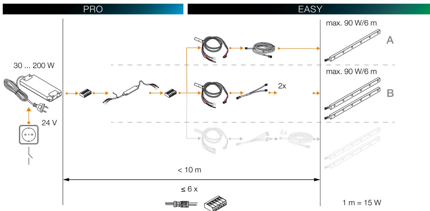
**Nota :** Longueur max. des modules LED du système LIPROTEC-EASY avec ajout de l'adaptateur Plug & Play : 6 m selon configuration (A ou B) en fonction du bloc d'alimentation choisi.
