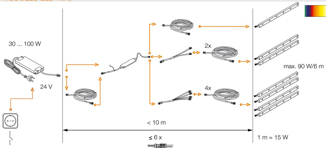
**Nota :** Ne pas raccorder ensemble plusieurs blocs d'alimentation.
