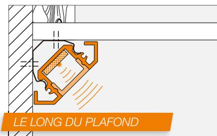
**Nota :** Dans la douche, privilégier une pose verticale. Si l'installation doit être horizontale, nous recommandons d'utiliser notre module LED LIPROTEC-LLPM mentionné page 12.
