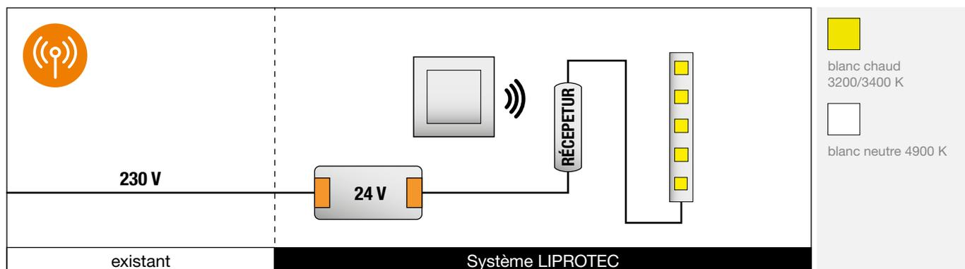
Commande radio pour installation en série (interrupteurs et récepteurs maître/esclaves) ..... Page 72
